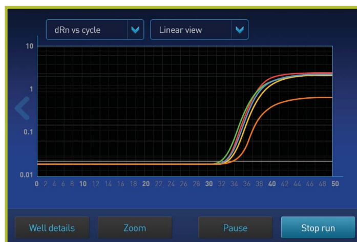
図1. インタラクティブ タッチスクリーン画面上で、サイクル条件 (A) の編集やプレートレイアウトを簡単に確認することができます。また、ラン中にその増幅曲線 (B) やウェル毎の状況を確認することができます。
