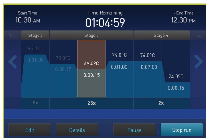
図1. インタラクティブ タッチスクリーン画面上で、サイクル条件 (A) の編集やプレートレイアウトを簡単に確認することができます。また、ラン中にその増幅曲線 (B) やウェル毎の状況を確認することができます。
