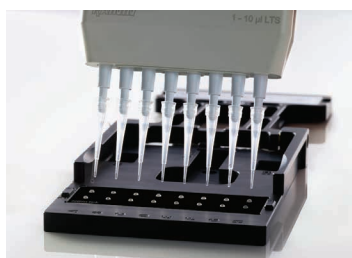
図 2. Agilent BioTek Take3 微量サンプル測定プレートと Agilent BioTek Epoch 2 吸光度プレートリーダーを使用すると、複数の 2 \mu L サンプル中の核酸やタンパク質を直接定量できます。
