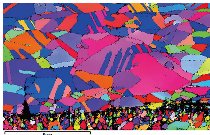
硬質断面の EBSD 分析, GeminiSEM 460 20 kV, 5 nA, 20 分で 185,000 ポイント取得
