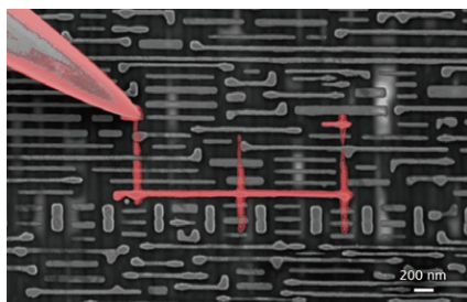
14 nm SRAM の EBAC (電子ビーム吸収電流法) 解析。InLens 像 (8 kV) と EBAC データ (赤) の重ね合わせ。
