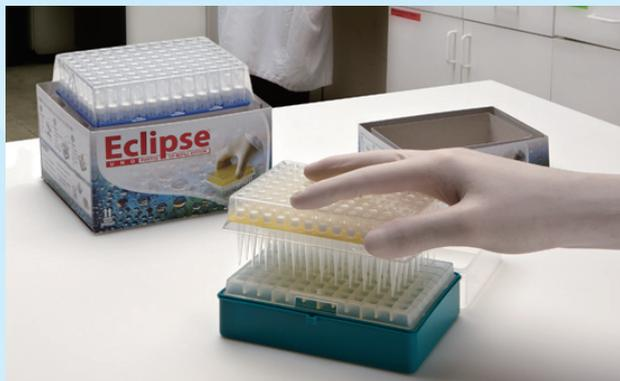
② チップをラックにセット。スナップロードカバーを上から押し込み、ラックにプレートを固定させて完成。
