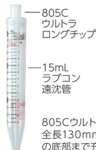
805Cウルトラロングチップは全長130mmあるので遠沈管の底部まで充分届きます。
