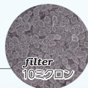
エンドトキシンフリーの10ミクロン疎水性多孔質フィルター (Inset1参照) は特許を取得しており、エアロゾルからのコンタミネーションを防ぎます。(ZAP™Slik Low Retention Aerosol tipsはローバインディングフィルターチップと同じ製品です。)
