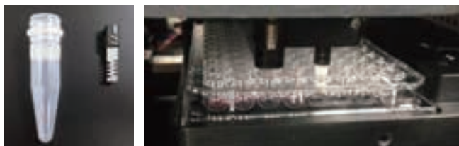
ミキサーパドルが各ウェルを測定前に攪拌
