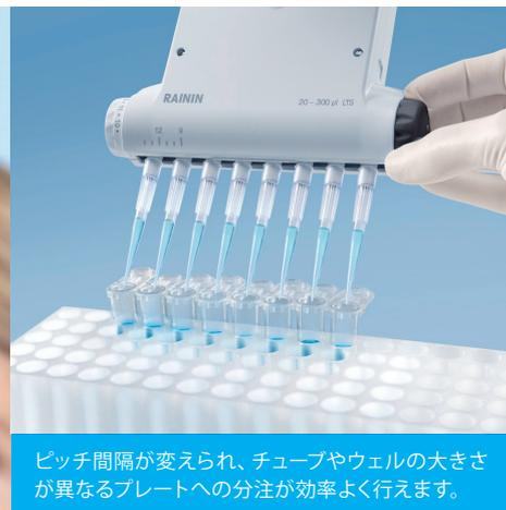
ピッチ間隔が変えられ、チューブやウェルの大きさが異なるプレートへの分注が効率よく行えます。
