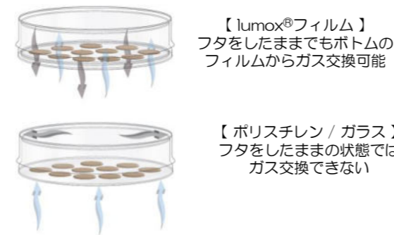
【lumox®フィルムのガス交換イメージ】
